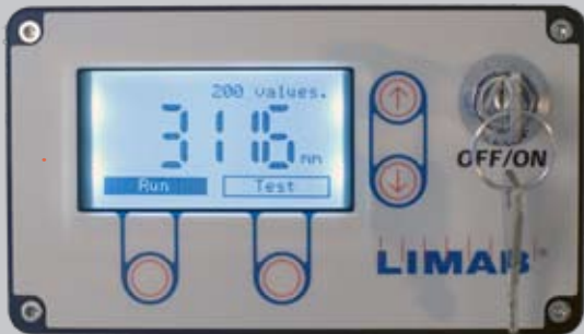
Anzeige der gemessenen Länge am Sensor.
