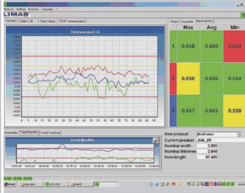
Bildschirmanzeige Dickenmessung mit 3 Messpositionen Min-, Max- und Mittelwert, sowie Trendgraphik
