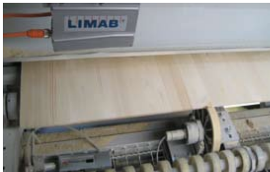
System PanelProfiler TR: Sensoren auf einer Linearvorrichtung.
