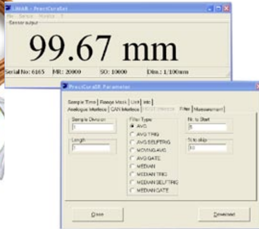
Programming kit. Windows basierte Set-Up Software und Kommunikationskabel zwischen Sensor und PC. Dies wird zur Konfiguration und Überwachung eines einzelnen Sensors benötigt.
