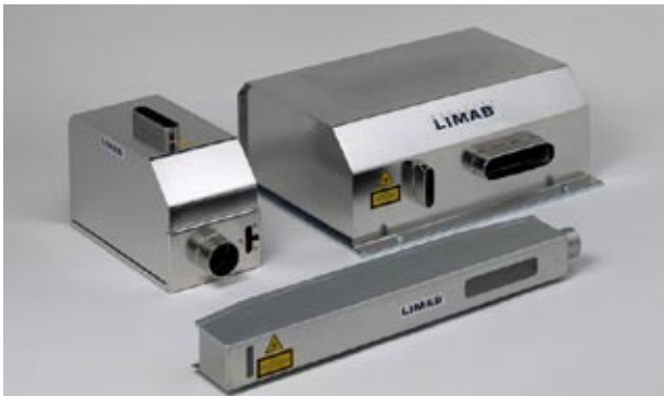
Schutzkasten. Diese können auch mit einer Heizung mit Temperaturkontrolle für Anwendungen im Außenbereich ausgestattet sein. Die Ventilatoren erzeugen einen Überdruck im Schutzkasten um das Sensorfenster sauber zu halten.
