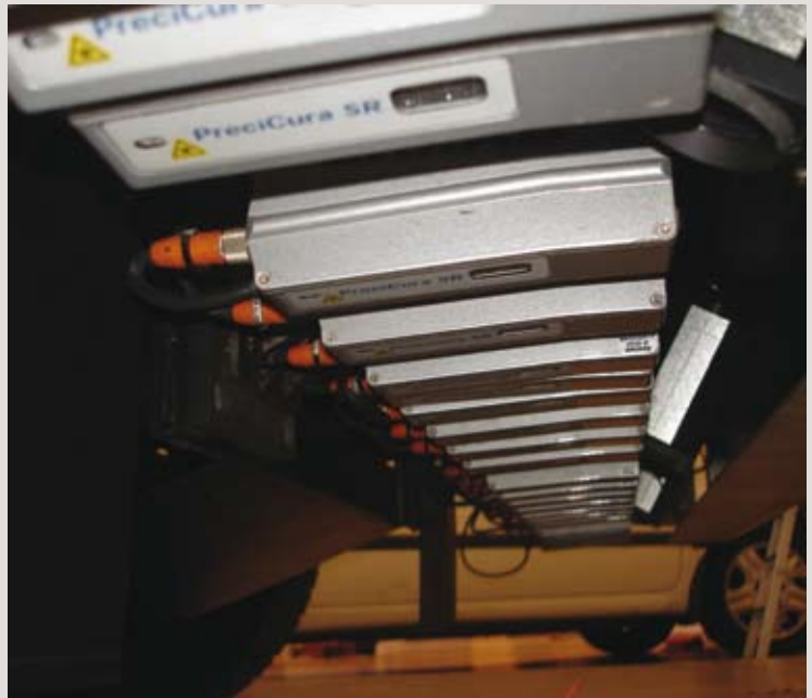
PreciCura SR Road an einem Profiler.
